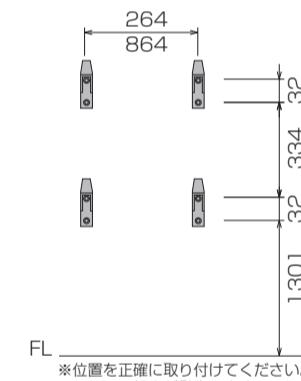
※位置を正確に取り付けてください。ミラーの傾きが発生します。
